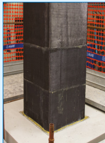
Pilastro confinato con MapeWrap C UNI-AX System
