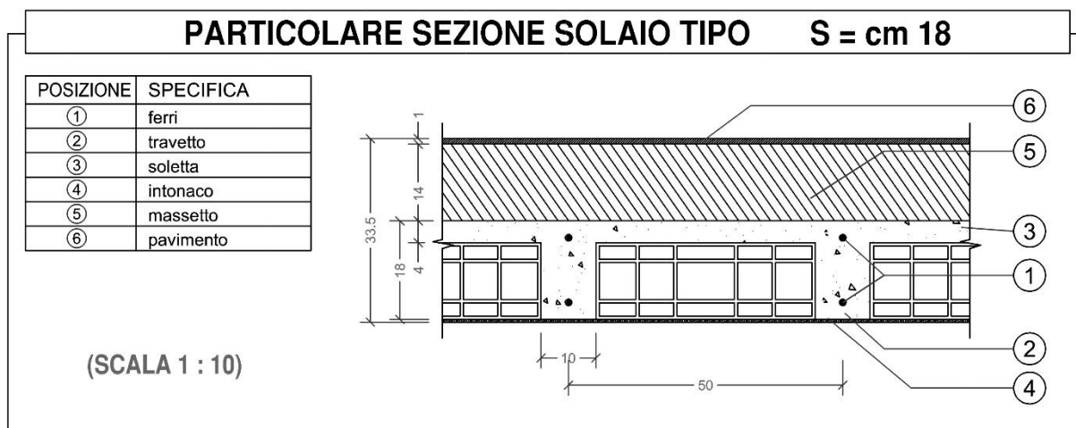
Figura 3 - Particolare della sezione di un solaio interpianto con altezza strutturale H = 18 cm
