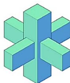
Nodo interno interamente confinato
