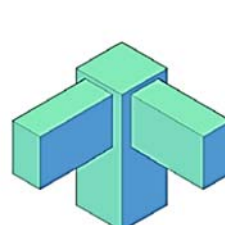
Nodo d'angolo di copertura non interamente confinato
