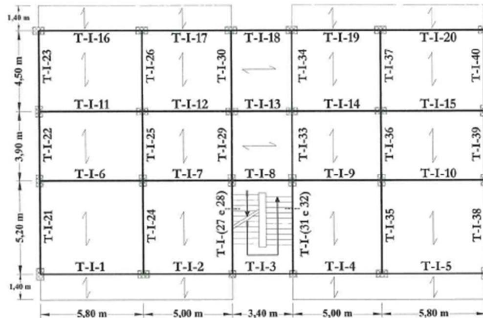
Fig. 2.9 Orditura dei solai e numerazione travi del primo livello
